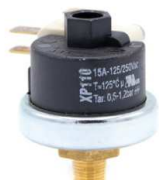
V594 Pressostato XP110 1/8"G regolabile 0,5-1,2 bar XP110 1/8" G pressure switch adjustable 0.5-1.2 bar
